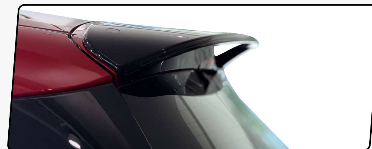
Aleron de techo
